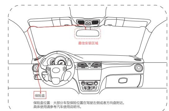
2：后路记录仪安装位置，电源线布线方式示意图
